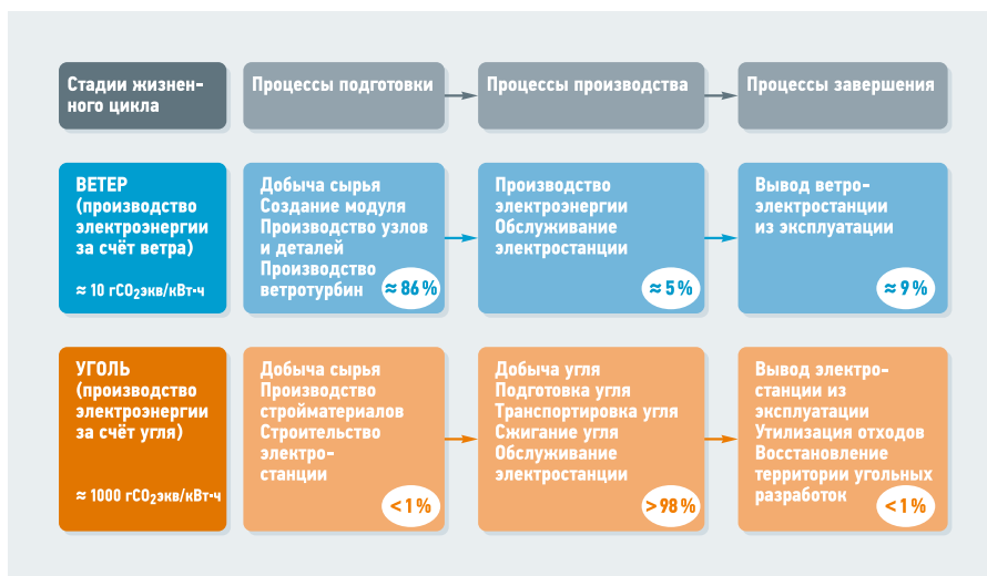
Рис. 1. Распределение эмиссии парниковых газов по стадиям жизненного цикла для ветряной и угольной энергетики (данные National renewable energy laboratory, NREL)
