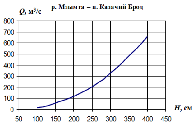
Рисунок 8.1. Кривая зависимости между расходами Q и уровнями воды H в створе р. Мзымта – п. Казачий Брод
