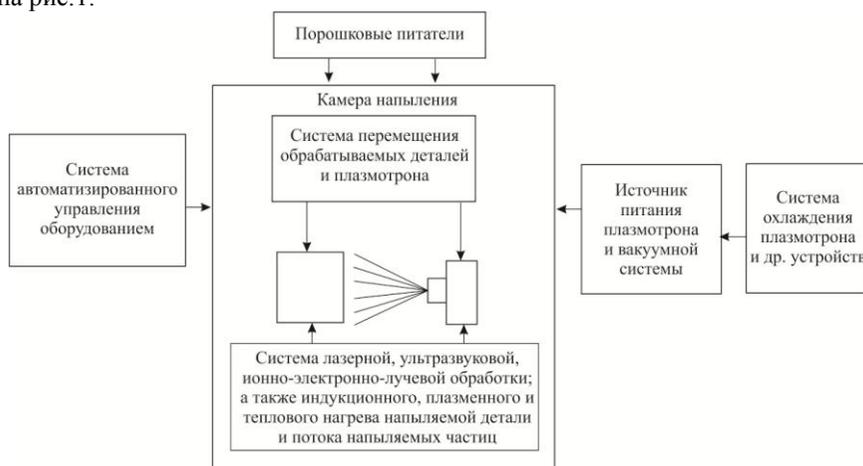
Рис. 1. Структурная схема оборудования для электроплазменного напыления газопоглатителей
