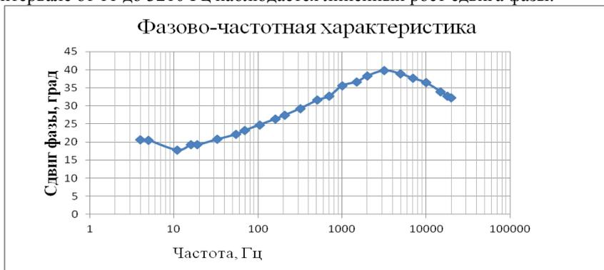
Рисунок 1- Фазово-частотная характеристика водонефтяной эмульсии
