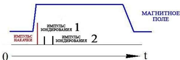
Рис.1. Взаимное расположение импульсов света (накачки и зондирования) и магнитного поля.
