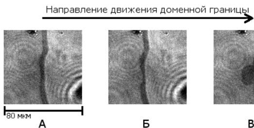
Рис. 2. Двукратные фотографии динамической доменной границы: А в отсутствие импульса накачки, Б и В в присутствии импульса накачки. Скорость движения ДГ 400 м/с,  $W_{\text{pump}} = 1.3$  мВт.
