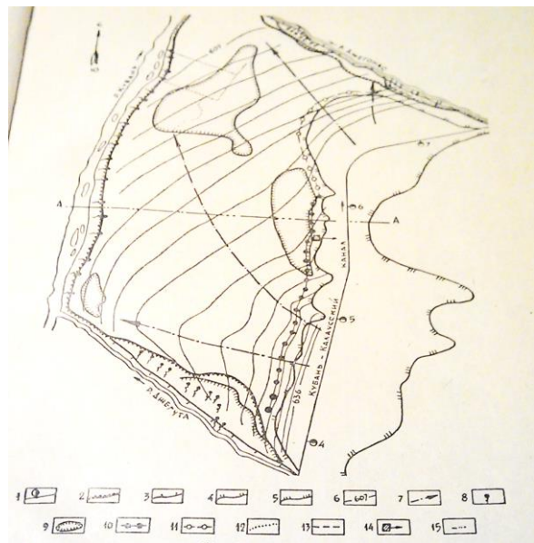
Рис. 3. План территории ст. Усть-Джегутинской с гидрогеологической ситуацией на октябрь 1965 г. [по 10, с. 15]: 1 – Ось канала. 2 – Обрывистый уступ главной верхнечетвертичной эрозивно-аккумулятивной террасы р. Кубань. 3 – Уступы аккумулятивных отложенных террас рр. Джугута и Джегонас. 4 – Сглаженный уступ стадияльной эрозивно-аккумулятивной верхнечетвертичной террасы р. Кубань. 5 – Бровка эрозивной среднечетвертичной террасы р. Кубань. 6 – Гидрогипсы. 7 – Направление движения грунтовых вод и путей разноса наложенного потока ирригационных вод. 8 – Родники. 9 – Очаги подпоплення (глубина залегания подземных вод 0–1,5 м). 10. Вертикальный дренаж I очереди. 11 – Вертикальный дренаж II очереди. 12 – Горизонтальный дренаж закрытого типа I очереди. 13 – Горизонтальный дренаж закрытого типа II очереди. 14 – Насосная станция по перекачке дренажных вод в канал. 15 – Линия геолого-литологического разреза
