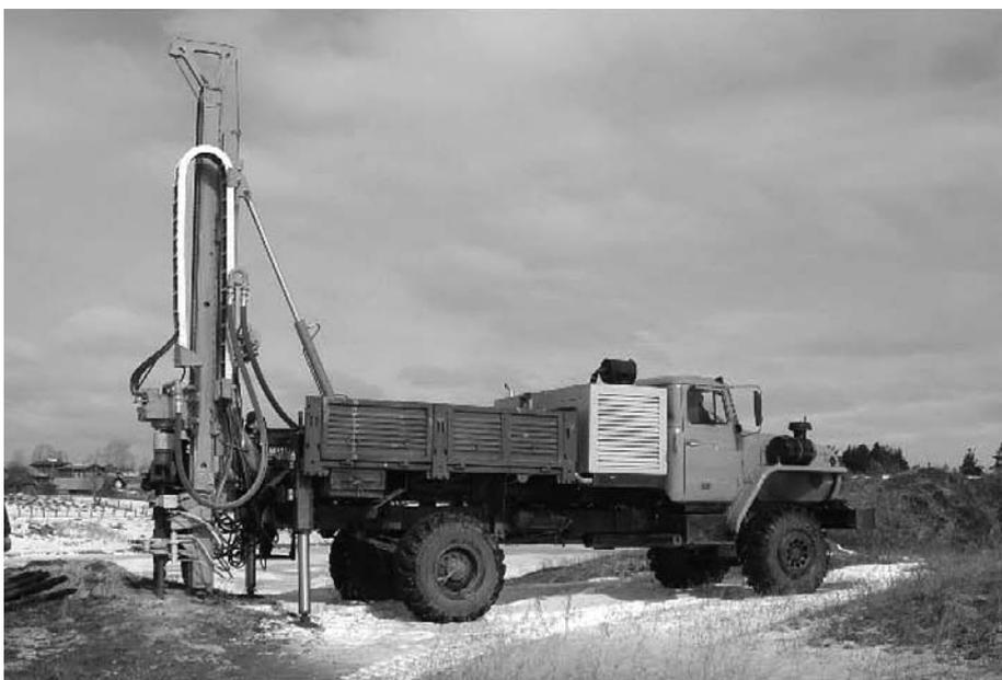
1. ООО «Геопроект» из Республики САХА (Якутия) при выборе буровой установки придерживалось следующих критериев: машина должна быть надежной, с небольшой массой, на шасси УРАЛ с высокой проходимостью и производительной. Этим объясняется выбор – БГМ-12 с максимальным набором дополнительных опций. К ним относятся не только лебедка со свободным сбросом, немецкий вращатель с функцией смещения от оси скважины, гидравлический хомут для работы с обсадными трубами, но также зажим для буровых штанг.
