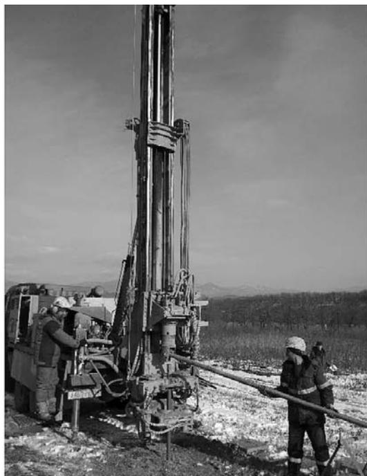
3. ООО «Стройтехбурение» (г. Мирный, Якутия) остановило свой выбор на УРБ-51 с двойным зажимом для облегчения и ускорения погружения и подъема обсадных труб. Наличие такой опции позволило существенно повысить производительность работы установки при работе с обсадными трубами в сложных условиях работы в регионах Якутии.
