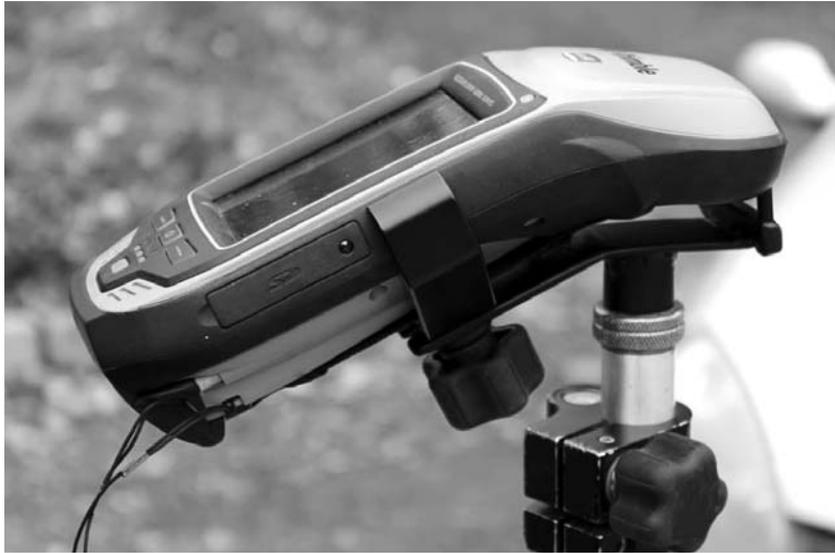
**Рис. 1. GeoXR в режиме измерения с использованием встроенной антенны**
