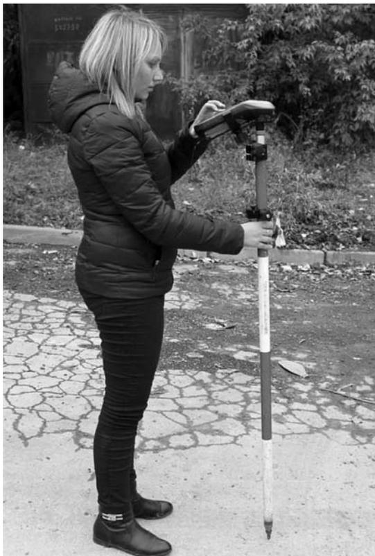
**Рис. 2. Выполнение съемки приемником GeoXR**
