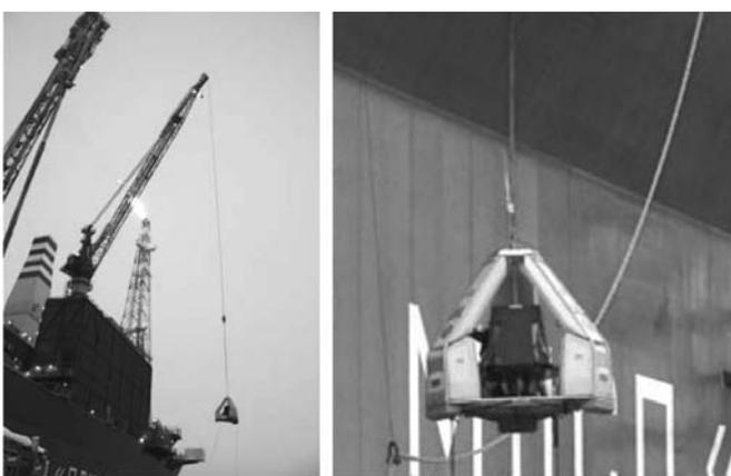
**Рис. 3. Перемещение людей с ГТС на судно при помощи специального модуля (фото Головина Н.В.)**
