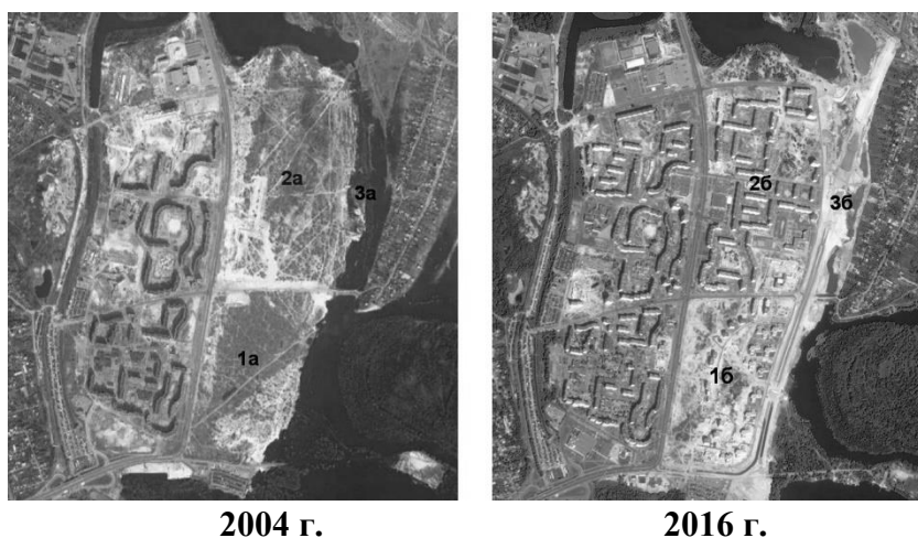
Рисунок 1 – Интенсивность техногенного освоения поймы реки Сож (1а и 1 б – 18 микрорайон «Приозерный»; 2а и 2б – 19 микрорайон; 3а и 3б – участок трассы «Восточный обход»)
