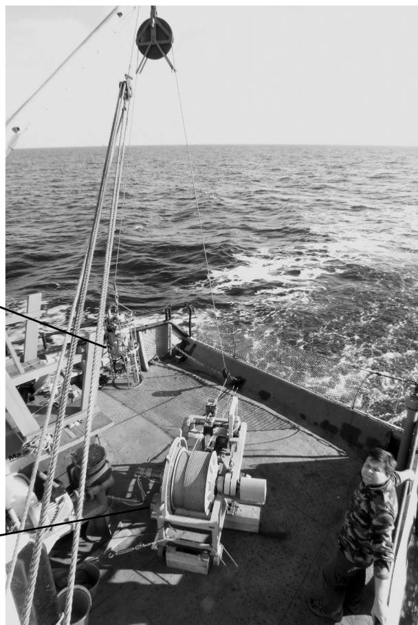
Рис. 1. Размещение измерительно-технологической платформы на палубе научно-исследовательского судна “Денеб”: многоканальный гидролого-оптико-химический зонд (1); лебедка морская электрическая (2). Справа один из разработчиков комплекса А.Л. Оленин
