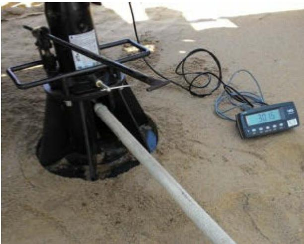
**Рис. 1. Иллюстрация испытания песчаного основания штампом**
