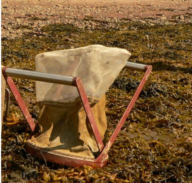
Рисунок 2.3.1. Зубчатый водолазный дночерпатель Грузова, площадь 0,025 м 2 (фото Герасимовой А.В.)
