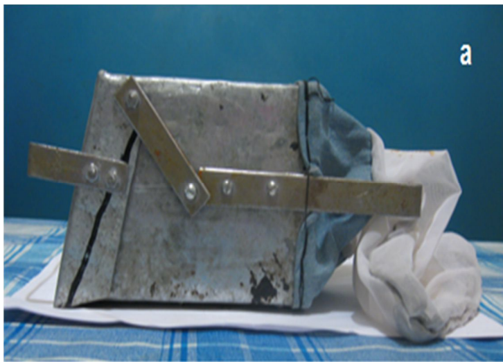
Рисунок 2.3.2. Модифицированный дночерпатель типа «Surber» площадью 0,01 м 2
