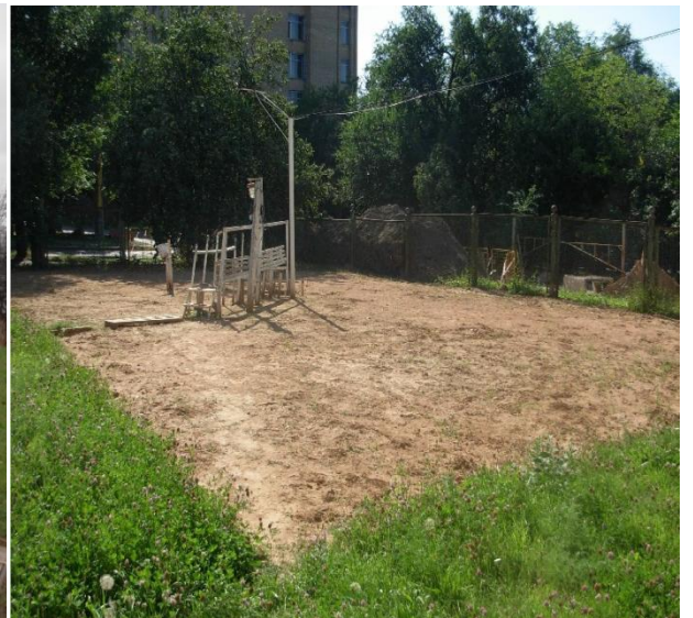
Рисунок 2.1 - Измерения температуры грунта на глубинах в МО МГУ: а) на специальной вспаханной площадке; б) на участке с естественным покровом; в) на участке с оголённой поверхностью.
