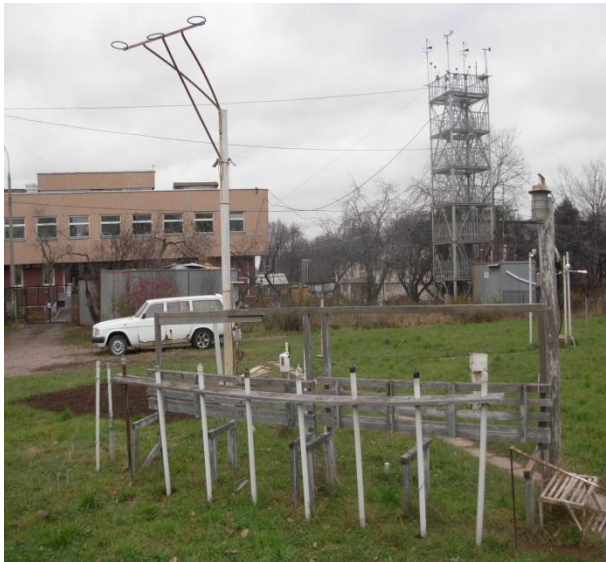
Рисунок 2.1 - Измерения температуры грунта на глубинах в МО МГУ: а) на специальной вспаханной площадке; б) на участке с естественным покровом; в) на участке с оголённой поверхностью.
