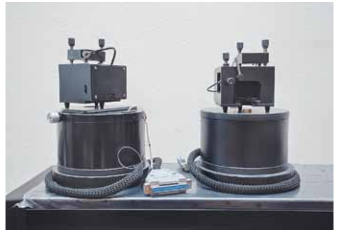
Рис.2. Сканирующие зондовые микроскопы "ФемтоСкан" (ЦМИТ "Нанотехнологии", Москва)
