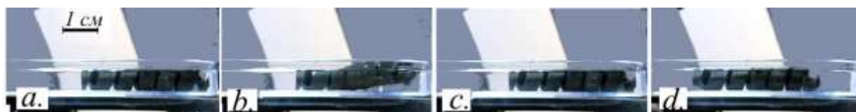
Рис. 1. Движение тела из намагничивающегося эластомера в воде в однородном магнитном поле H : (a) – t=0 , H=0 ; (b) – t=1 с, H=430 Э; (c) – t=2 с, H=0 ; (d) – t=42 с, H=0 .
