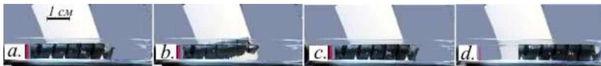
Рис. 2. Движение тела из намагничивающегося эластомера в глицерине в однородном магнитном поле H : (a) – t=0 , H=0 ; (b) – t=1 с, H=430 Э; (c) – t=2 с, H=0 ; (d) – t=42 с, H=0 .
