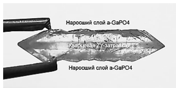
Рис. 2. Эпитаксиальный рост \alpha -GaPO 4 на монокристаллической кварцевой ZY – затравке.
