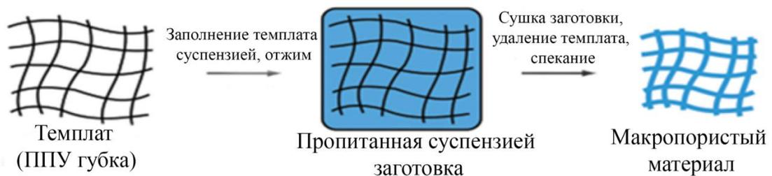
Рисунок 1.16 – Получение пористой керамики методом реплик [121].
