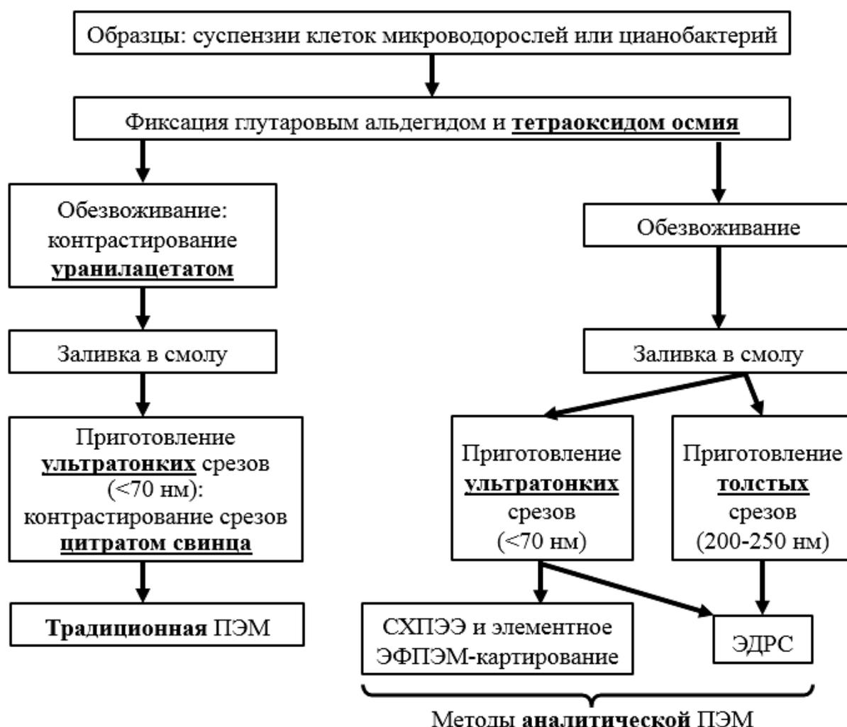
Рис. 11 Обобщенная схема подготовки образцов в представленной работе для анализа методами традиционной и аналитической просвечивающей электронной микроскопии (ПЭМ). Подчеркиванием и жирным шрифтом выделены используемые контрастирующие соединения и тип получаемых срезов по толщине. Методы аналитической ПЭМ: СХПЭЭ – спектроскопия характеристических потерь энергии электронов, ЭДРС – энергодисперсионная рентгеновская спектроскопия, ЭФПЭМ – энергофильтрующая ПЭМ.
