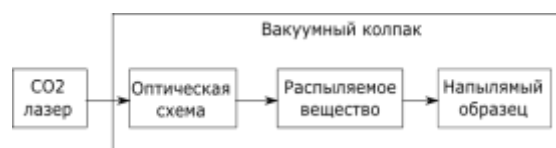
Рис.1. Блок-схема установки с CO 2 -лазером для осаждения УНТ.
