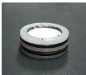
Рис. 1. Фильтр на основе углеродных нанотрубок.
