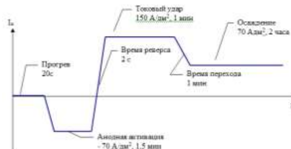
Рис. 1. Изменение плотности тока в процессе хромирования.
