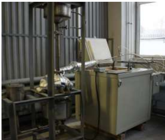
Рис.1. Опытная установка высокотемпературной щелочной активации углеродных материалов.
