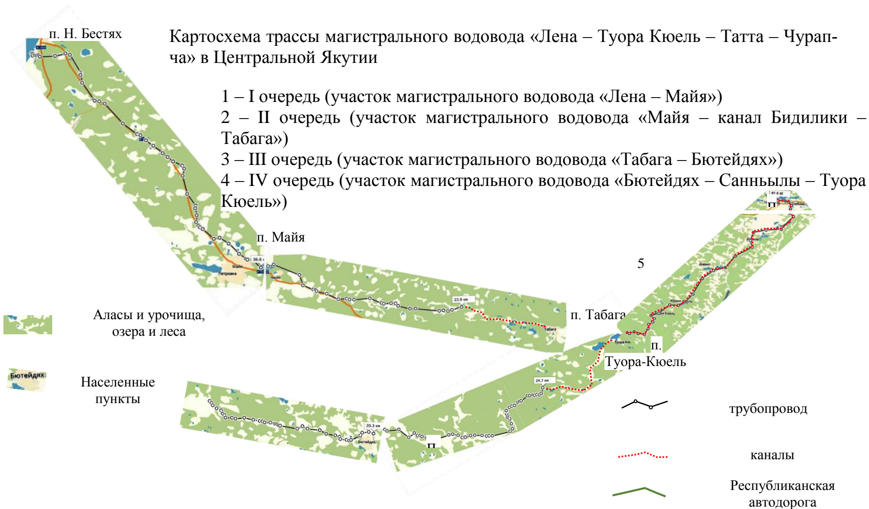
Рис. 1 – Картограмма трассы магистрального водовода в Центральной Якутии
