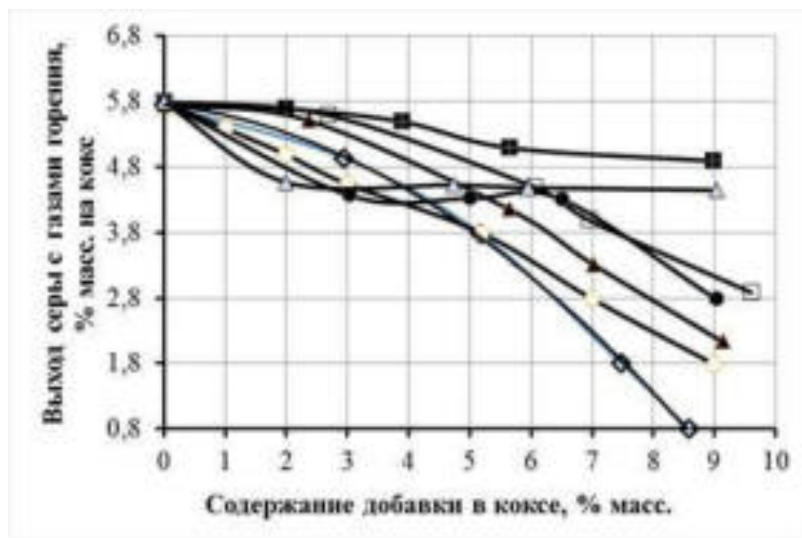
Рис. 1. Зависимость выхода серы с газами горения от содержания различных добавок в коксе:
