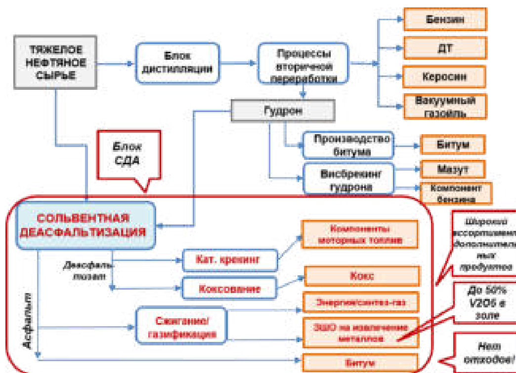
Рис. 1. Блок-схема интеграции технологии СДА в схему НПЗ
