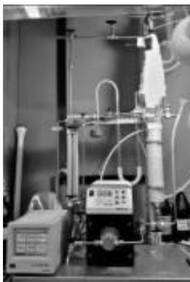
Рис. 1. Десорбционная установка для малоэнергоемкого процесса регенерации абсорбентов \text{CO}_2 на основе водных растворов моноэтаноламина: 1- десорбционный блок (а – десорбционная колонка с тефлоновыми кольцами Рашига ( \varnothing 6 мм); б – мембранный контактор газ-жидкость с композиционными половолоконными мембранами); 2- емкость с насыщенным абсорбентом; 3- насос с программируемым расходом; 4- блок показаний температуры абсорбента; 5- конденсатор; 6- нагреватель (лента ЭНГЛ-1); 7- охладитель (проточная вода).
