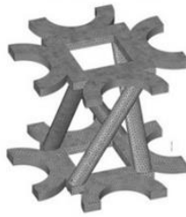
Рис. 1. Типичная ячейка и пакет ячеек, формирующих метаматериал.
