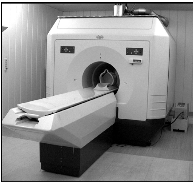
Рис. 7.3.1. Внешний вид 0.5 Тл МР-томографа Bruker Tomikon S50
