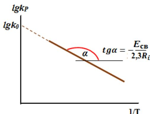
Рис. 2. Линеаризация температурной зависимости константы скорости реакции
