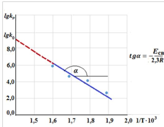
**Рис. 3.** Линеаризация температурной зависимости константы скорости глубокого окисления н-бутана
