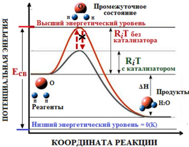
**Рис.1.** Условная диаграмма некаталитической и каталитической реакции окисления водорода
