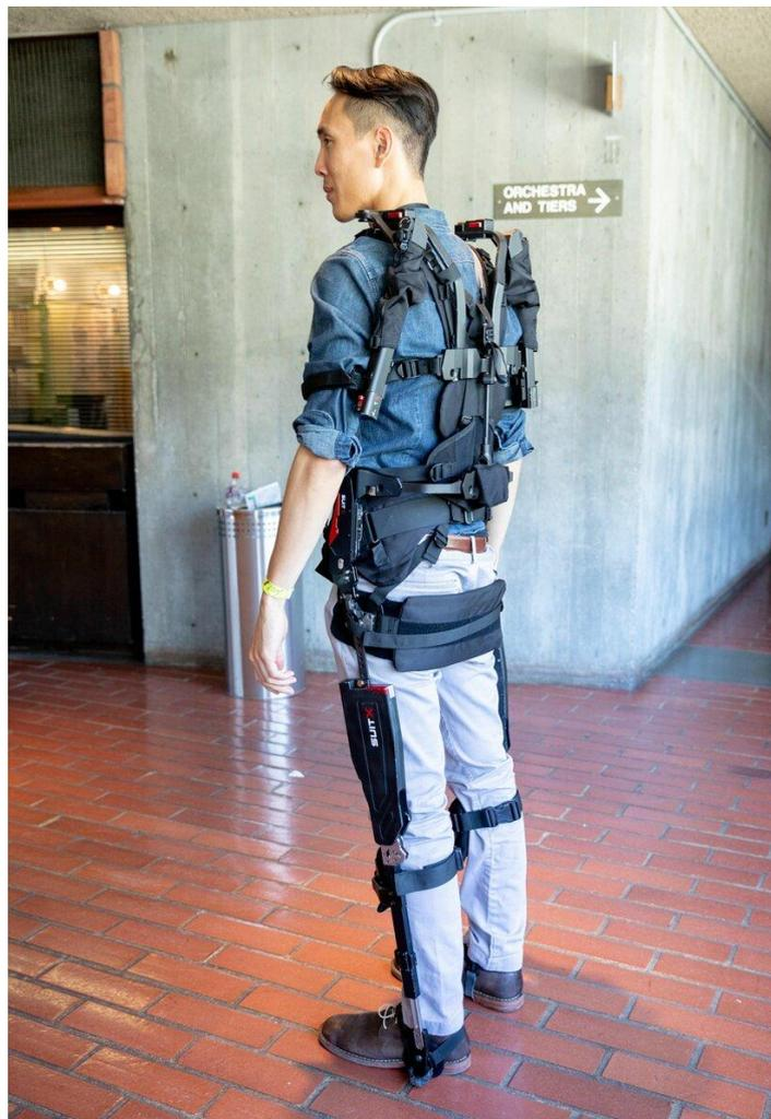
**Рис. 1. Экзоскелет MAX компании SuitX, состоящий из трех модулей: backX, shoulderX и legX – спина, плечи, ноги**
