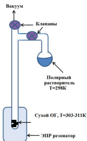
Рисунок 1. Схематическое представление образца ОГ, насыщаемого полярной жидкостью через газовую фазу
