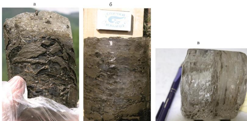
Рис. 3. Ледогрунт, глубина 1,8 м (а - керн перевернут на 180°) и 1,9-2,0 м (б) и чистый лед, глубина 4,5-4,6 м (в).
