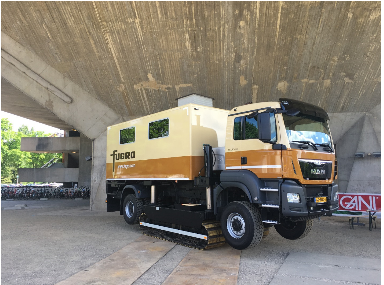
Рисунок 18 — Тяжелая установка статического зондирования Фугро с подвесной гусеничной платформой на базе а\м MAN (фото автора)
