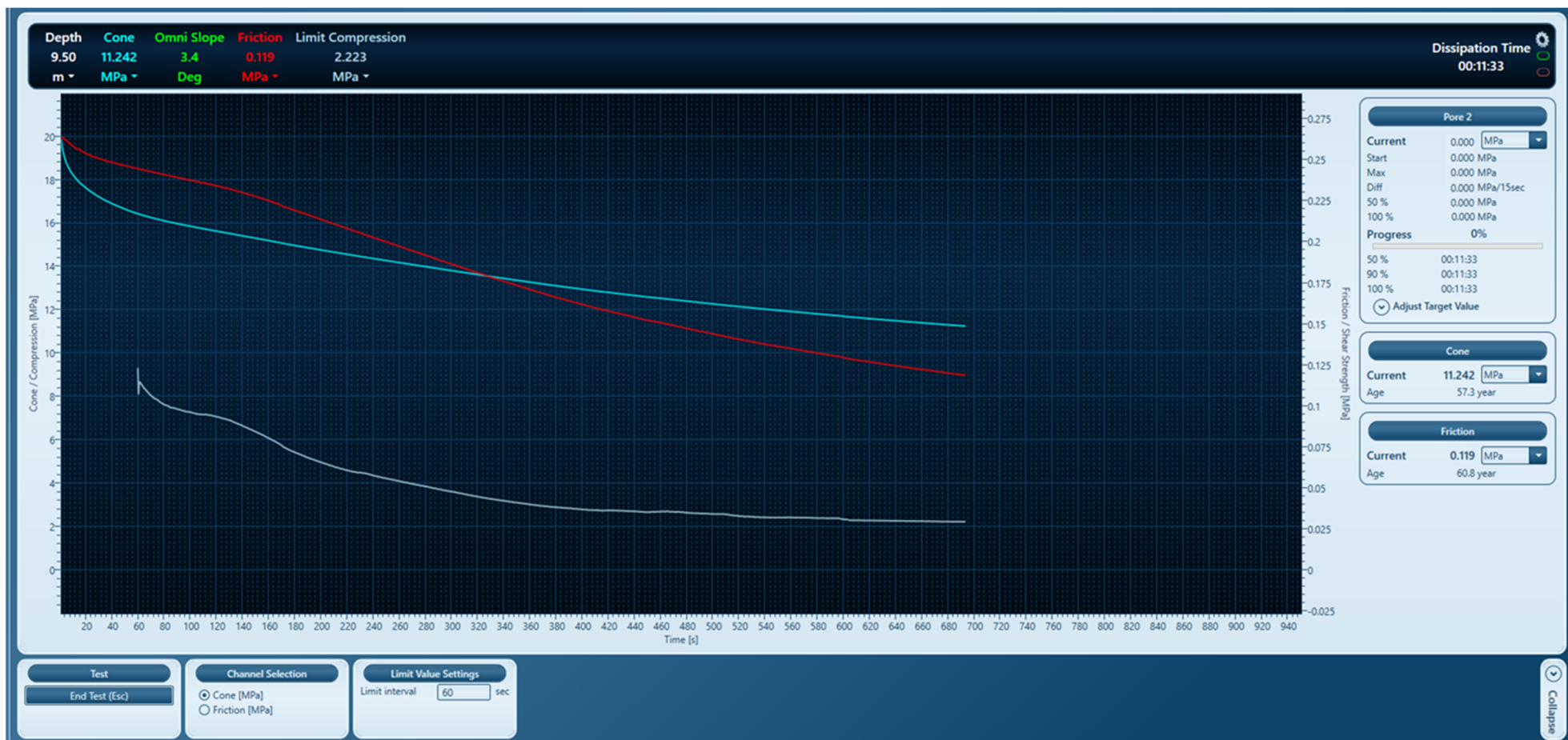
Рисунок 59 — Полевой замер релаксации напряжения в мерзлом грунте (время замера – 11 мин.)
