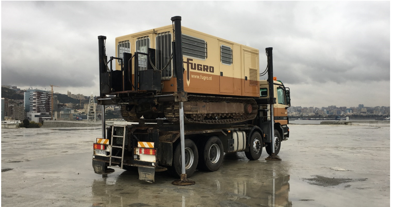
Рисунок 19 — Установка статического зондирования Фугро на гусеничном ходу (фото автора)
