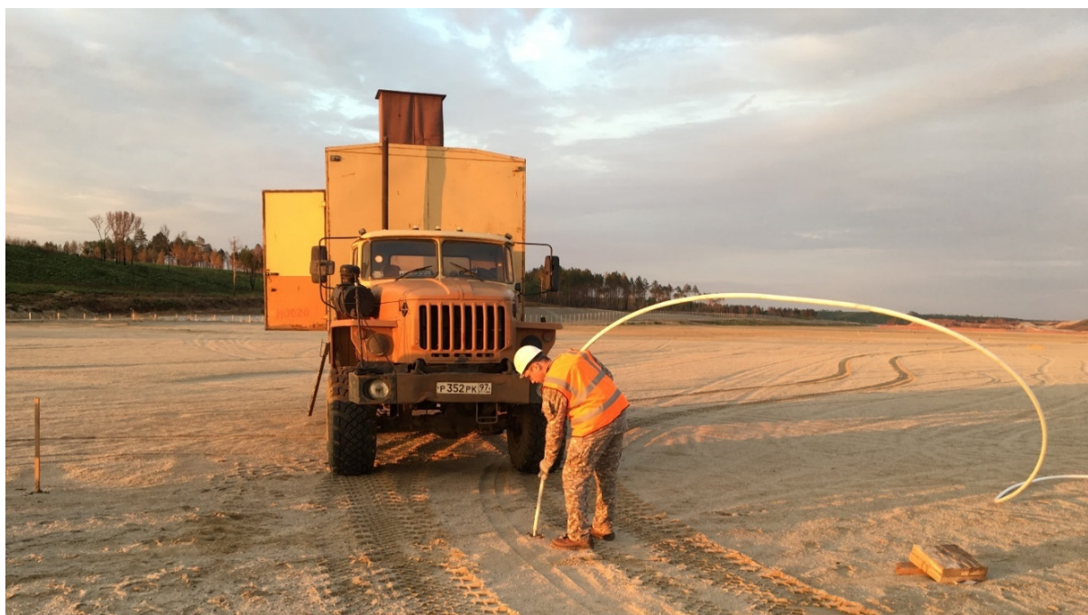
Рисунок 34 — Этапы установки обсадной трубы в термометрическую скважину, 1-я минута (фото автора)
