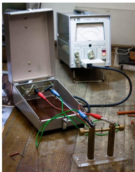
Рисунок 2.14 – Изображение измерительной установки: экранированный бокс, тераомметр и держатель образца.
