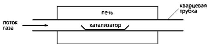
Рисунок 1.5 – Схема установки для получения нанотрубок методом пиролитического газозафазного осаждения.
