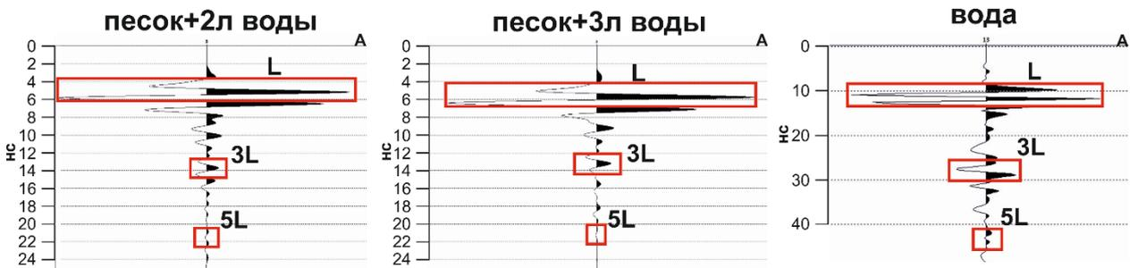
Рисунок 2.33. Примеры трасс при различных измерениях с выделенными областями кратных волн.
