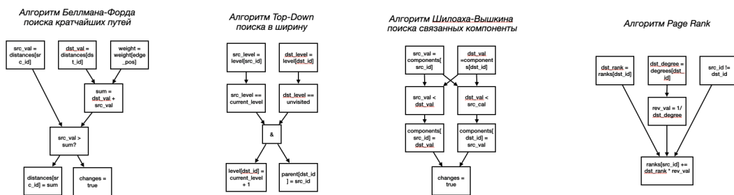
Рисунок 3.6 — Алгоритмические шаблоны нескольких графовых алгоритмов. Каждый из алгоритмических шаблонов представляют собой группу из элементарных операций, выполняемых для обработки ребер графа
