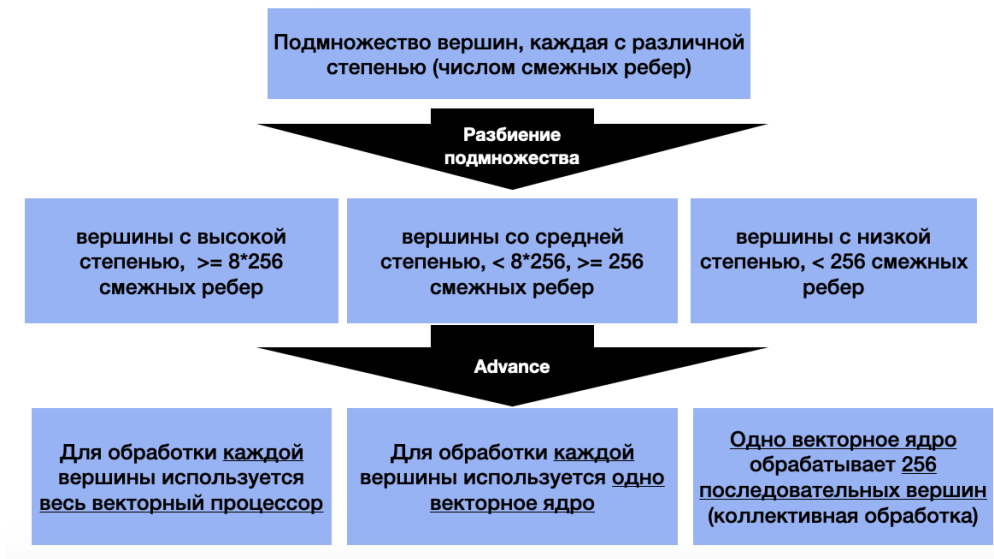
Рисунок 3.11 — Схема обработки групп вершин с различной степенью на векторной архитектуре NEC SX-Aurora TSUBASA в абстракции advance
