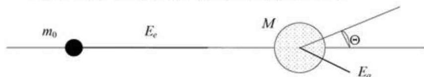
Рис. 1.1. Схема упругого взаимодействия быстрого электрона с атомом кристалла
