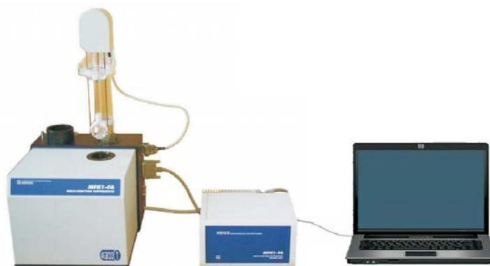
Рис. 2.3. Определение магнитной восприимчивости.
