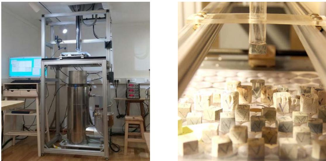
Рис. 2.4. Определение вектора естественной остаточной намагниченности.
