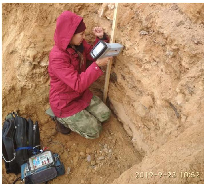
Рис. 3.1. Измерения петрофизических свойств в естественном залегании.
