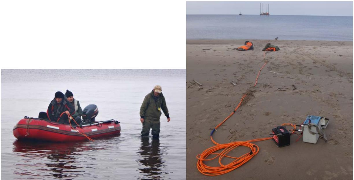
Рис. 4.3. Размотка косы с лодки и электроразведочная станция на берегу.
