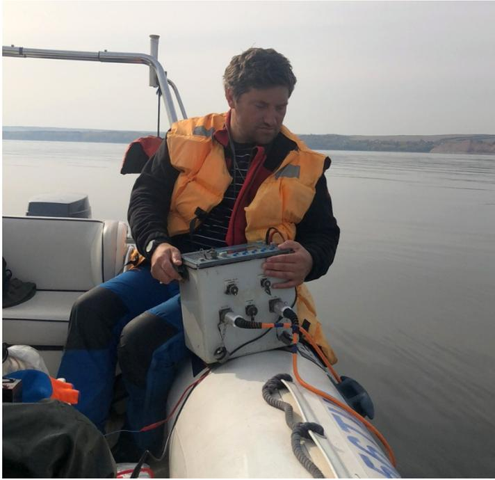
Рис. 4.2. Выполнение измерений донной электротомографии с резиновой лодки.
