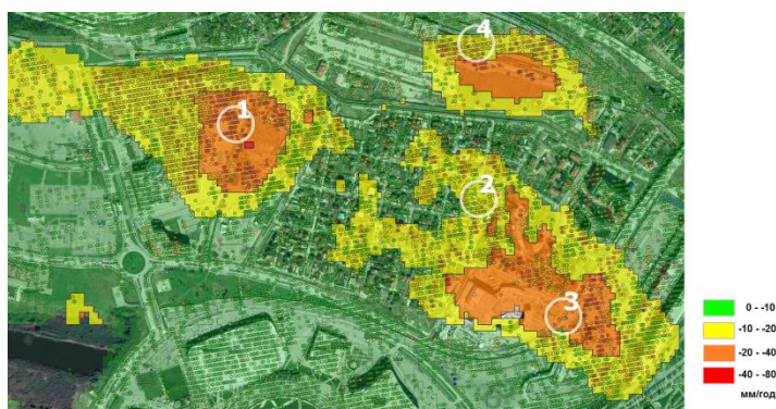
Рисунок 2.13 – Фрагмент наложения карт средних скоростей вертикальных смещений в направлении LOS по 67 снимкам S-1A за период 04.10.2017-17.12.2019 (SBAS ENVI SARscape) (сплошным цветом) и 33 снимкам со спутников S-1A и B за период 05.10.2018-27.04.2019 (PS StaMPS/MTI) (точки).
