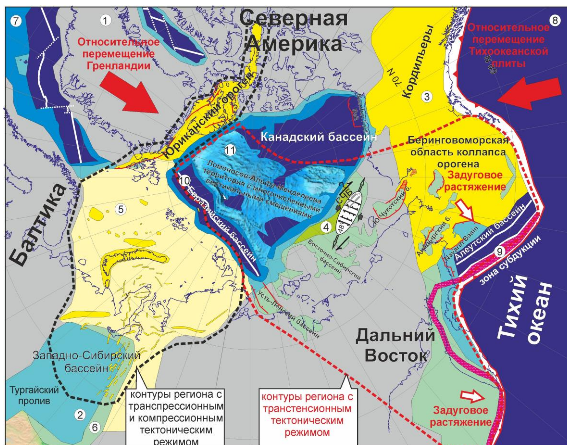
Рис. 8 Два региона с различными внутриплитными тектоническими режимами. Зона с транспрессионным режимом включает Баренцево-Карский шельф и Западную Сибирь. Зона с трансензионным режимом включает территорию Евразийского бассейна, хребтов Альфа-Менделеева, шельфа Восточной Сибири и Берингоморо-Охотский регион. Полученный эллипсоид деформаций для района исследования обозначен белым цветом (составлено Никишин А.М., Фрейман С.И.).
