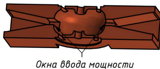
Рис. 1.34. Макет девятой ячейки с двумя симметричными окнами ввода мощности
