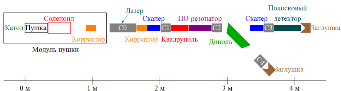
Рис. 2.1. Схема линии диагностики пучка в проекте GunLab
