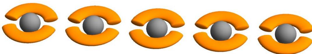
Рис. 20. Цепочка составных частиц – планарная цепочка кольцевых резонаторов с двумя разрезами и цепочка магнитных сферических частиц, вложенные друг в друга.
