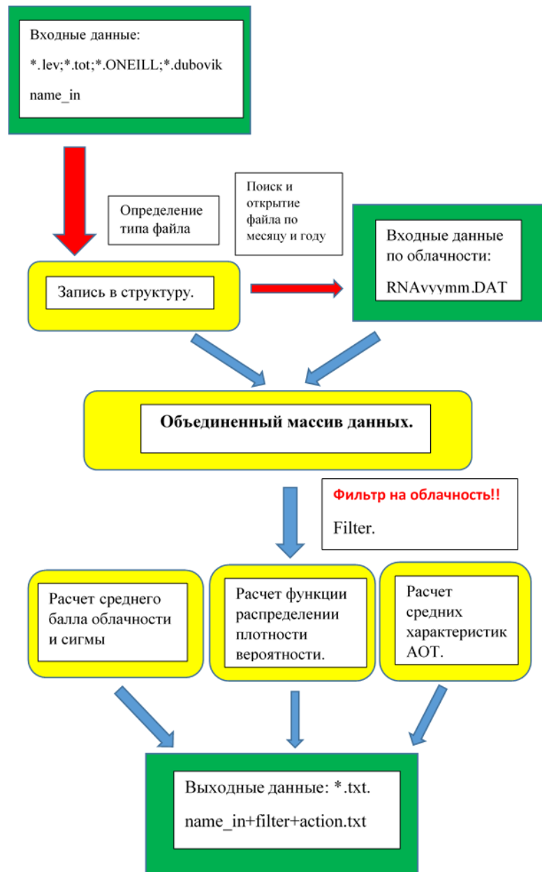
Рисунок 2.1.4 Блок-схема программы AEROCLO.
