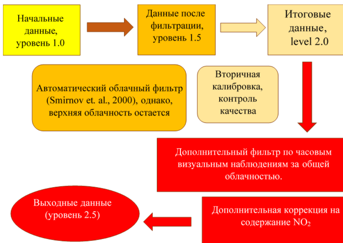
Рисунок 2.1.3 Схема обработки данных измерений AERONET
