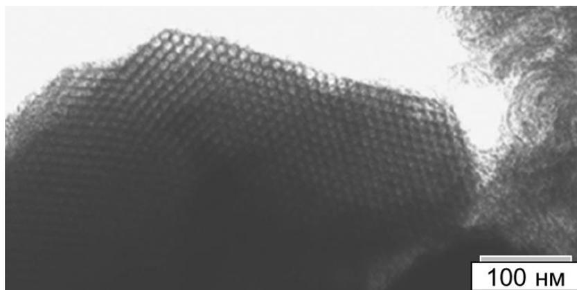
**Рисунок 29.** Микрофотография образца мезопористого материала SBA-15
