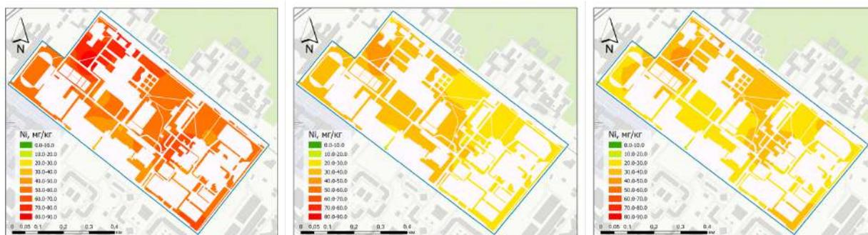
**Рис 2.** Картограммы пространственного распределения ТМ (на примере Ni) на территории кампуса РУДН на основе разных методов оценки: pXRF, ICP и скорректированного pXRF (слева направо).
