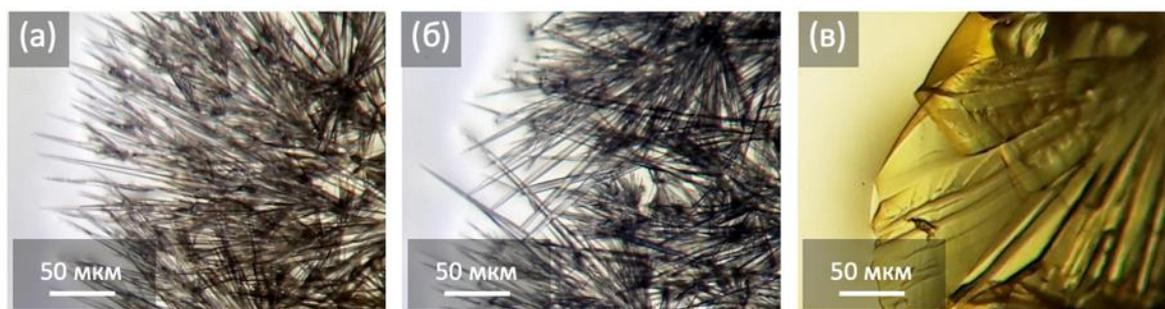
Рисунок 51. Внешний вид кристаллов, полученных путём испарения растворителя в каплях насыщенного раствора с разным соотношением MAI/PbI<sub>2</sub> в DMF: (MA)<sub>2</sub>Pb<sub>3</sub>I<sub>8</sub>·2DMF (а), MAPbI<sub>3</sub>·DMF (б) и (MA)<sub>3</sub>PbI<sub>5</sub>·DMF (в).
