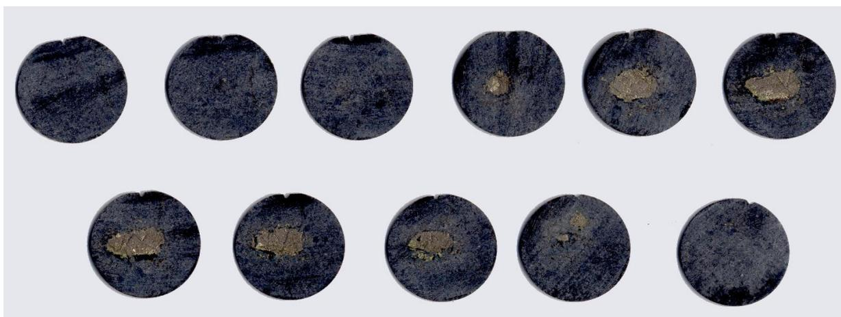
Рисунок 16. Фотография 11 пластин, на которые был распилен миникерн (диаметром 15 мм) с сульфидной каплей из образца DV627-1-2 после выбуривания из закалочного пикродолерита по результатам крупномасштабной КТ-съемки.
