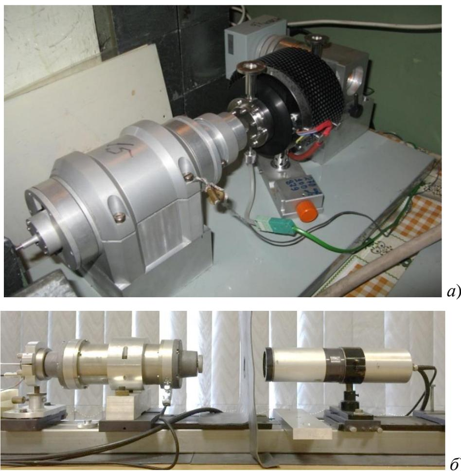
Рисунок 11. Фотографии мессбауэровских спектрометров *а)* MS-1104Em, *б)* производства WissEl.
