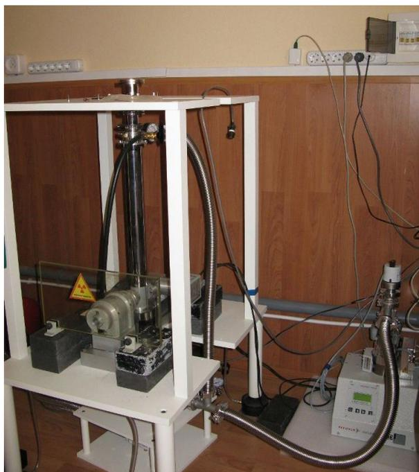
Рисунок 12. Фотография гелиевого криостата SHI-850-5 совместно со спектрометром MS-1104Em.
