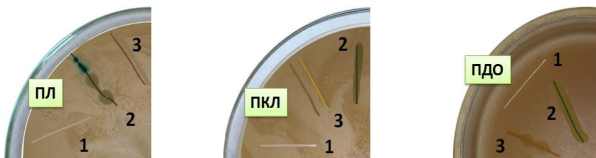
Рисунок 48. Результаты микробиологических испытаний для образцов исходных пористых полиэфирных волокон (1) и образцов, содержащих БЗ (2) или йод (3) в культуре Candida albicans .
