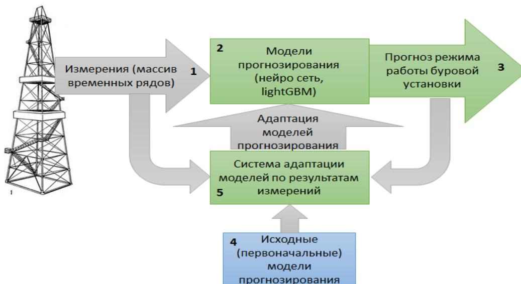
**Рис. 5. Принципиальная структурная схема ПКНР**
