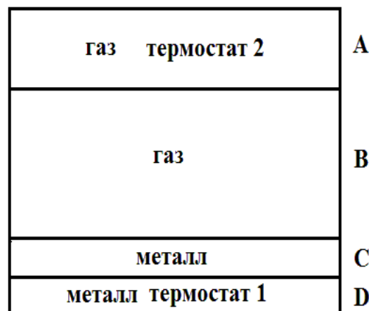
Рисунок 5.2 – Плоская проекция расчетной области с разделением на вертикальные слои, отличающиеся составом среды и способами внешнего влияния на нее: А – верхний слой газа с фиксированными параметрами, В – нижний слой газа, С – верхний слой металла, D – нижний слой металла с фиксированной температурой
