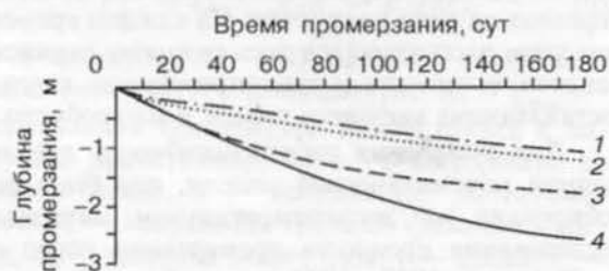
Рис. 5. Промерзание грунтов в зависимости от интенсивности снегонакопления.
