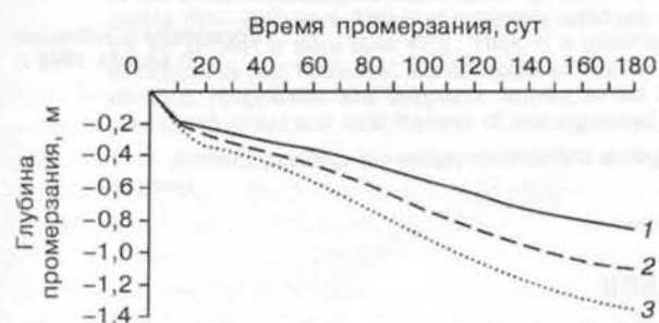
Рис. 7. Промерзание грунтов в зависимости от температуры воздуха.
