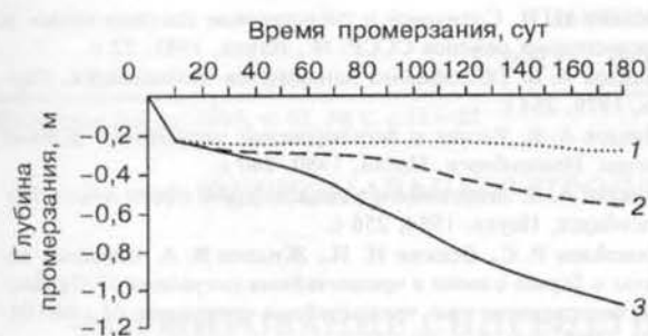
Рис. 6. Промерзание грунтов в зависимости от толщины снежного массива на их поверхности.
