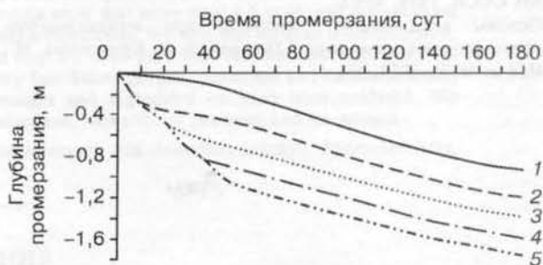
Рис. 8. Промерзание грунтов от времени задержки выпадения снега после установления отрицательных температур воздуха.
