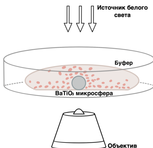
Рисунок 16. Схема эксперимента в режиме проходящего света.
