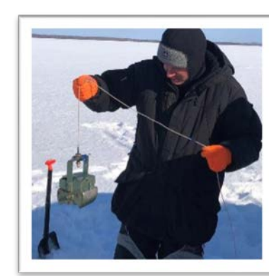
Отбор проб донных отложений дночерпателем Экмана-Берджи
