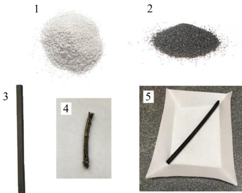
Рис. 27. Внешний вид сорбционных материалов, используемых в работе: 1 –Tenax-TA, 2 –Tenax-GR, 3 – композиты из SiC (M4/M40) и БНК ( l = 4 см), 4 –углеродный сорбент на основе вспененного графита ( l = 4 см), 5 – монолит из резорцина ( l = 4 см).
