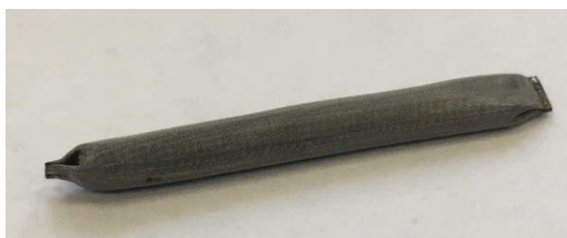
Рис. 29. Сорбент, помещенный в металлическую сетку.
