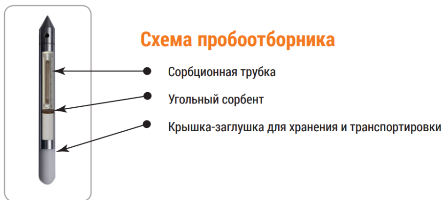
Рис. 20. Конструкция пассивного дозиметра «РС-5» [107].
