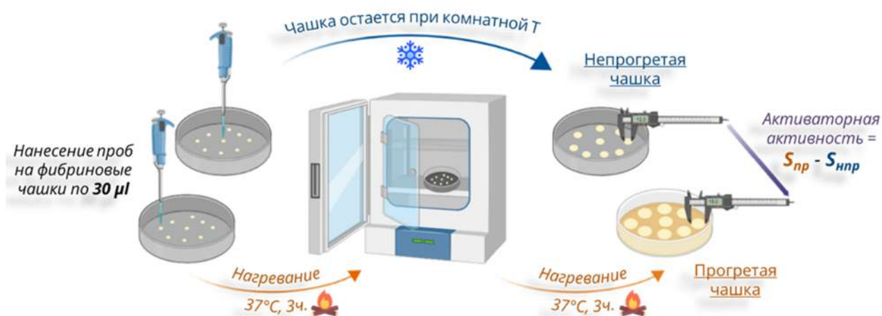
Рисунок 25. Схема эксперимента (основные этапы) по определению фибринолитической и активаторной к плазминогену активности на фибриновых пластинах
