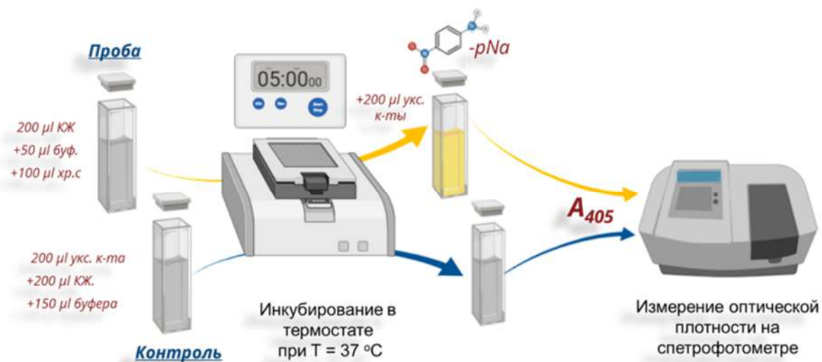
Рисунок 26. Схема эксперимента (основные этапы) по определению активности протеиназ с хромогенными пептидными субстратами
