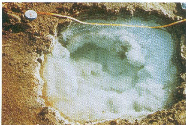
Рис. 5. Новообразования карбонатов и гидроксидов в пустотах намытых зологрунтов (фото Е.Н. Огородниковой).
