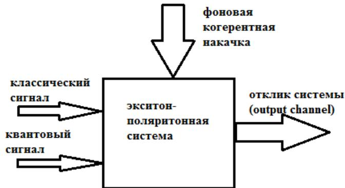
Рисунок 30 – Схема поляритонного квантового логического управляемого элемента “И”.
